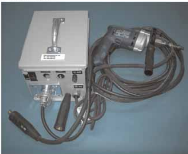
爐釘焊接設備
